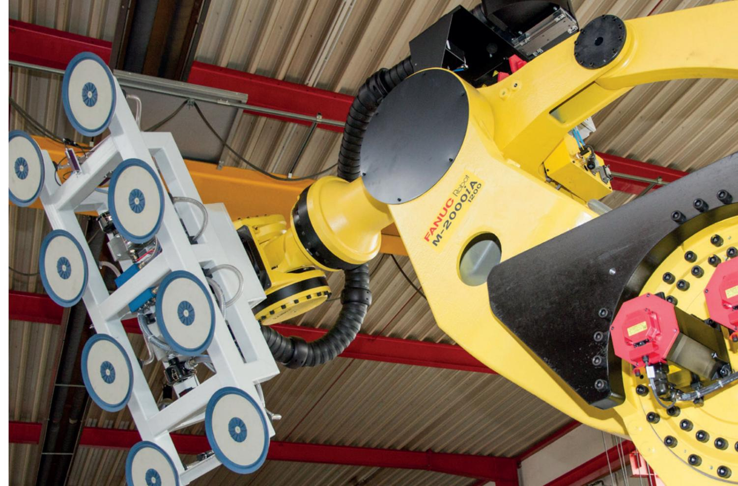
**Greifen mit Lageerkennung** gestattet die Lokalisierung der Werkstücke durch Kameratechnik, lagespezifisches Greifen ohne vorherige Ausrichtung, Erkennen und Aussortieren der zu greifenden Werkstücke nach Qualitätsmerkmalen bzw. nach Produkttypenmerkmalen.
